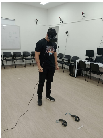
Figura 8.2.5.4. Ubicar los controles en el suelo para alinearlos con el suelo virtual.
